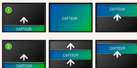
❶ Lorsque la vitesse effective est inférieure à la vitesse Synchro-X, le capteur est entièrement découvert et le flash éclaire bien toute la zone photosensible. ❷ À l'inverse, lorsque la vitesse effective est supérieure à la vitesse Synchro-X, le capteur n'est jamais totalement découvert et le flash n'éclaire qu'une partie de la scène, ce qui crée des bandes noires dans l'image, comme ci-contre.
