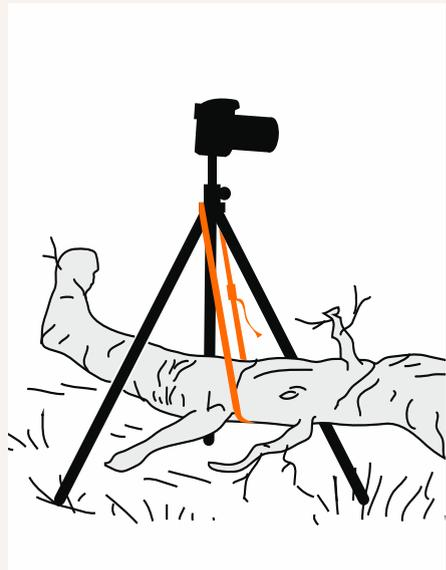
Une simple sangle judicieusement fixée permet souvent de rigidifier un trépied en exploitant un élément trouvé sur place.
