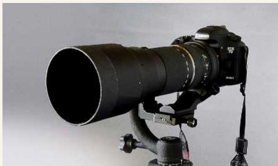
Si vous faites vos propres tests, soyez rigoureux : travaillez sur trépied avec une sensibilité ISO la plus basse possible, une vitesse élevée, le miroir relevé, en mode manuel et avec la balance des blancs verrouillée (pas « auto », donc).
