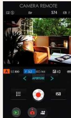
L'application Camera Remote de Fuji permet, sur les appareils de la gamme, de faire la mise au point et de déclencher à distance, mais aussi de gérer la vitesse, l'ouverture, la correction d'exposition et la sensibilité, tout cela à partir d'un smartphone ou d'une tablette !
