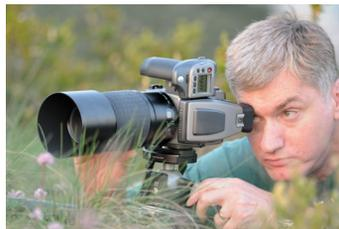
L'appui sur le déclencheur de l'appareil moyen format ne fournit pas du tout la même sensation que le claquement sec d'un boîtier petit format. C'est très bruyant et relativement lent. Il faut dire que le cycle de déclenchement du H4D-40 est beaucoup plus complexe que celui d'un reflex 24 × 36. Cela résulte de l'architecture de l'appareil articulée autour d'un obturateur central placé dans l'objectif.
