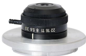
*Ce 20 mm Macro Canon est équipé d'une monture vissante de petit diamètre directement issue des standards des microscopes. Un adaptateur difficile à trouver est nécessaire pour le monter sur du matériel photographique. L'adaptateur présenté ici a été usiné par mes soins.*
