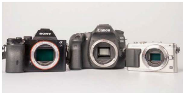
Voici les différents formats d'appareils photo, l'hybride full frame Sony A7, l'APS-C Canon EOS 80D et l'hybride micro 4/3 Olympus E-PL5.
