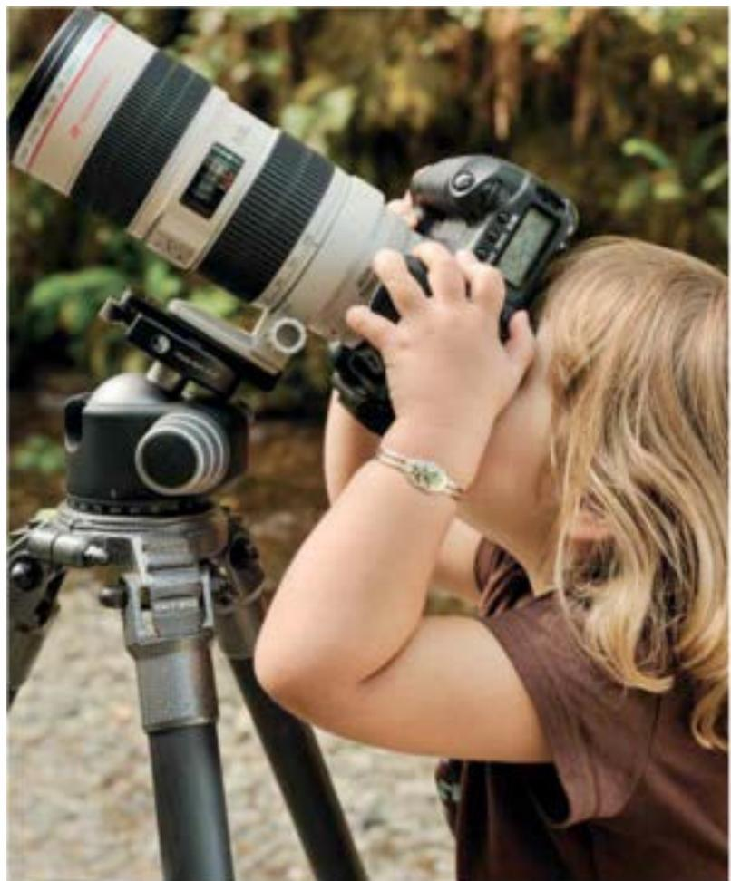
**Figure 1.23** Un support stable et équilibré (monté sur l'objectif au niveau du centre de gravité) permet à cette jeune photographe de se concentrer sur son sujet au lieu de s'inquiéter du risque de bougé. *200 ISO, 1/20 s, f/4,8, 38mm*
