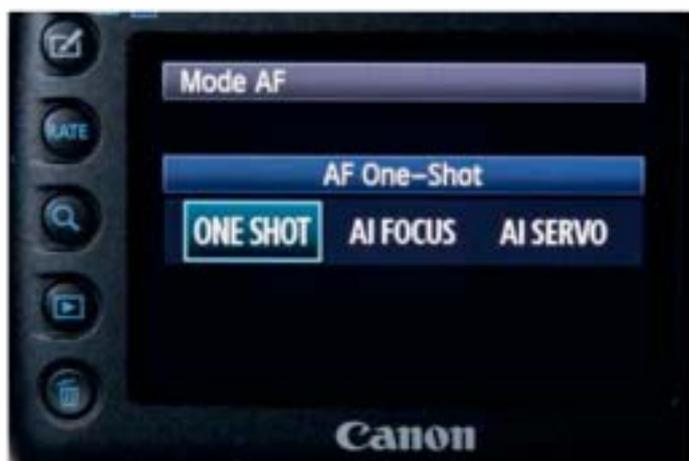
**Figure 2.8** Avant d'enfoncer le déclencheur, même à mi-course, choisissez un mode de mise au point : autofocus ponctuel pour les sujets immobiles, autofocus ajusté en continu pour les sujets animés ou mise au point entièrement manuelle.
